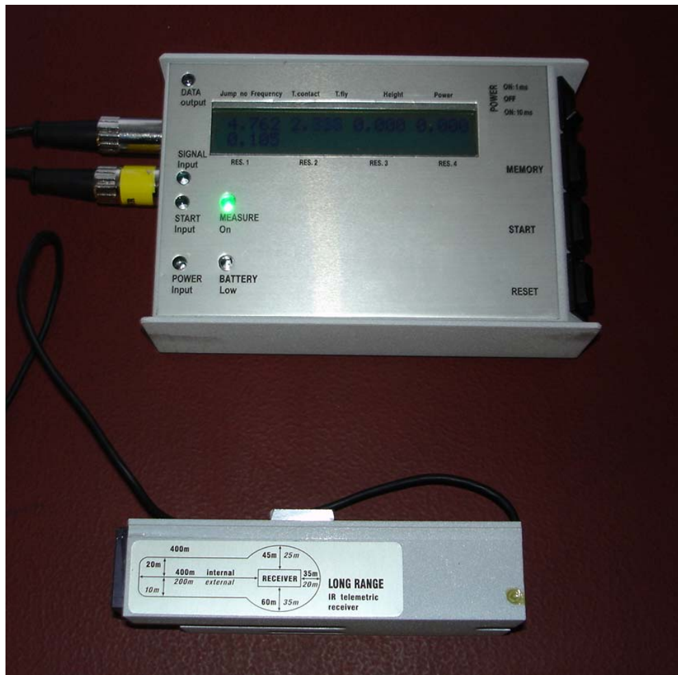
Lisa 3. Ivar Krause mõõtesüsteemi „Ivar” põhiblokk.
